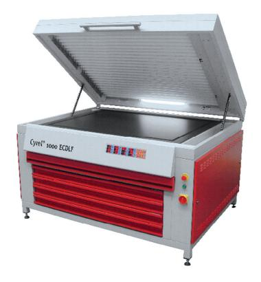
Les quatre tiroirs du four sont situés sous la section de Finition. Il y a une minuterie par tiroir afin de réguler la température ainsi que des ventilateurs automatiques sur deux tiroirs qui viennent de plus contrôler la température choisie. Le système d'évacuation de l'air est, quant à lui, contrôlé par un capteur de sécurité.
